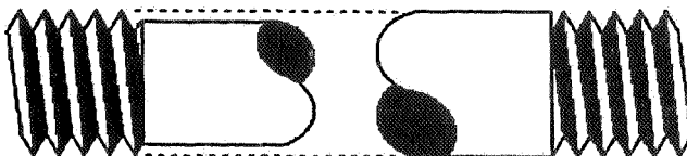
شکل ۱۷: مقایسه پیچ معمولی و پیچ بدنه نازک
